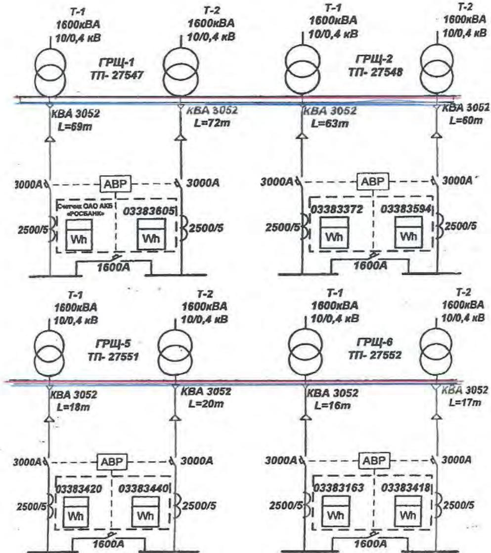
Примечание: В схеме указываются номера счетчиков, параметры измерительных трансформаторов, границы балансовой принадлежности (красный цвет) и эксплуатационной ответственности (синий цвет).
