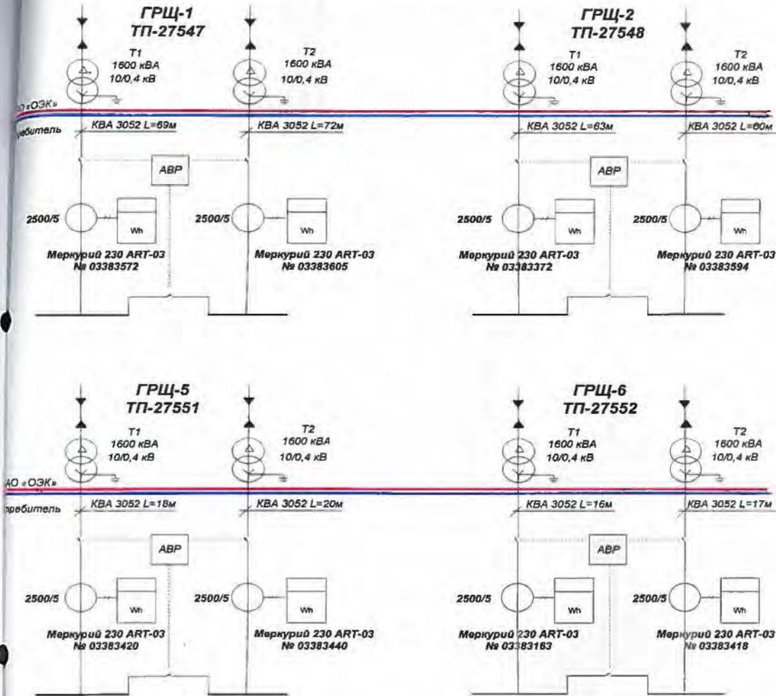
Примечание: В схеме указываются номера счетчиков, параметры измерительных трансформаторов тока и напряжения, границы балансовой принадлежности (красный цвет) и эксплуатационной ответственности (синий цвет).
